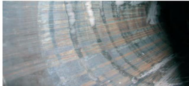
**Abrieb bzw. Beschädigung der Innenbüchsenbohrung:**
