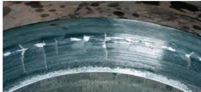
**Deformation und Risse an Dichtflächen:**
