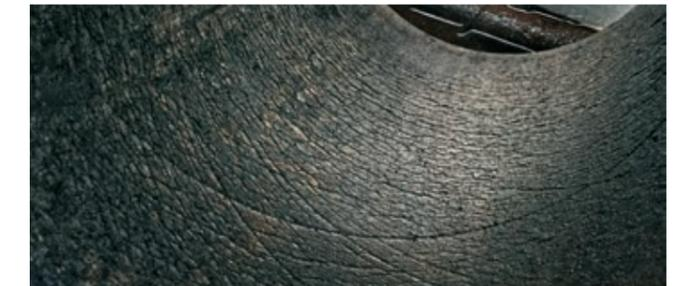
SA718 (1250 - 1400 MPa) nach 150.000 Cu-Pressbolzen, feines Rissnetzwerk
