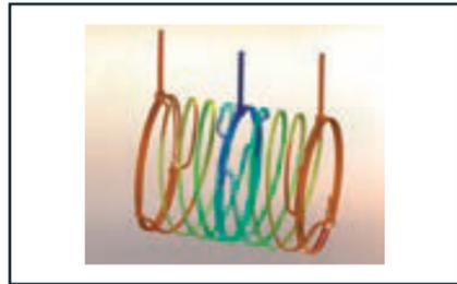
FEM-Simulation der Temperaturverteilung im Rezipienten
