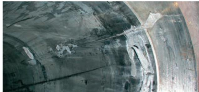
**Lufteinschlüsse zwischen Bolzen und Innenbüchse:**
