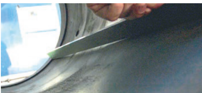
Umstellung des Rezipienten auf Luftkühlung; Verwendung von warmfesten Mantel-Werkstoffen und HTR-Zwischenbüchsen in Kombination mit SA718 Innenbüchsen
