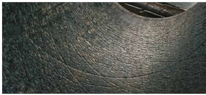
SA718 (1250 – 1400 MPa) nach 150.000 Cu-Pressbolzen, feines Rissnetzwerk
